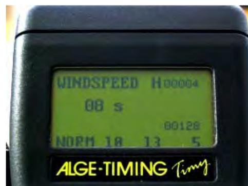
Se le misurazioni del vento sono terminate ed il tempo impostato esaurito, il WINDSPEED invia tutti i dati al TIMY. Questi dati saranno visualizzati sul display del TIMY e sulla schermata dell'operatore dell' OPTic.
