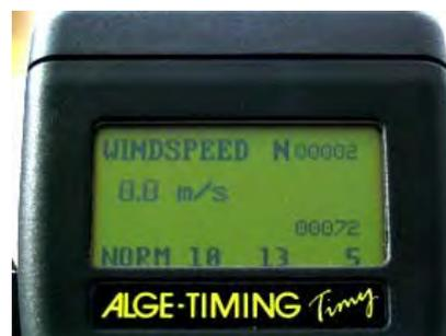
Quando viene registrato l'impulso di start, il TIMY invia un comando all'anemometro per avviare l'intervallo di misurazione impostato. Sul display, in alto a destra, appare "H" per segnalare che la misurazione è in corso. Il valore al centro segnala il tempo di misurazione residuo.
