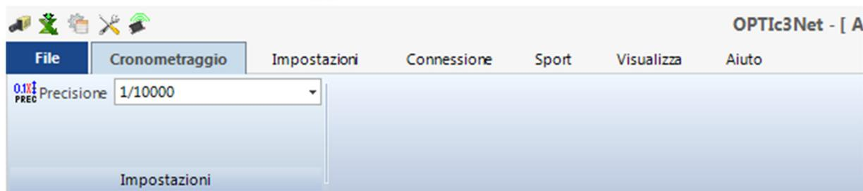
Nel menu <Cronometraggio> è possibile effettuare la sincronizzazione del cronometro (es. con altri apparecchi di cronometraggio) e selezionare la precisione utilizzata per il calcolo del tempo netto.
